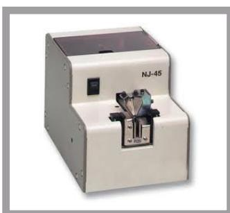
Les NJ sont des distributeurs de vis par vibrations. Ils sont compacts et peuvent recevoir une sélection de rails qui leur confère polyvalence et précision. Les vis de M1,4 à M5 jusqu'à 18 mm de longueur sous tête sont couvertes par la gamme NJ. La préhension des vis s'effectue par magnétisation ou par aspiration.
