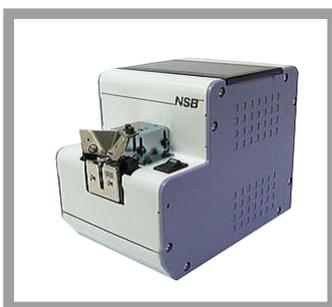
Les NSB sont des distributeurs de vis par vibrations. Ils sont compacts et hypers polyvalents puisqu'ils peuvent recevoir 8 rails de guidage qui couvrent les vis de M1 à M3 jusqu'à 20 mm de longueur sous tête.
