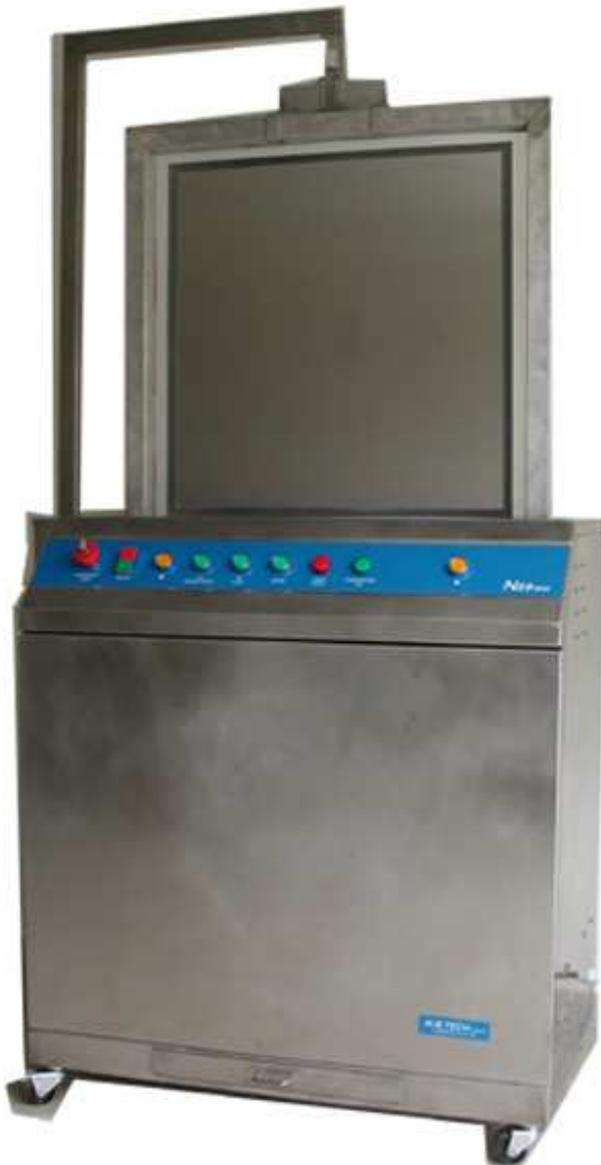
Spécialement conçue pour mettre en valeur le système MPC® (Micro Phase Cleaning) du Vigon SC200®, le pochoir immergé verticalement, soumis à l'action d'ultrasons perpendiculaires, est parfaitement nettoyé en quelques minutes. Le sécheur indépendant permet de travailler en temps masqué.
