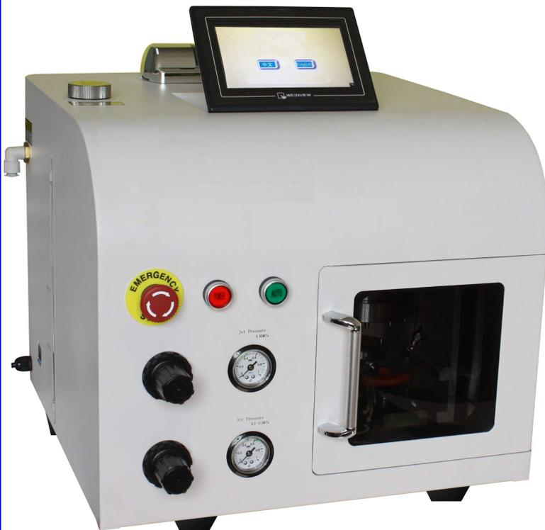
Spécialement conçue pour nettoyer 24 buses simultanément, cet équipement n'utilise que de l'eau déminéralisée pour son procédé de lavage. Les buses sont placées sur un plateau spécifique (un modèle de plateau par marque et modèle de machine « Pick and Place ») et sont soumises à un nettoyage de haute qualité grâce à un procédé de brouillard d'eau déminéralisée à haute vitesse.
