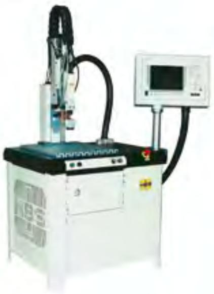
Il s'agit du procédé le plus innovant pour le **soudage d'écrous** par arc rotatif magnétique. Cette machine est spécialement conçue pour souder rapidement et proprement des écrous de diamètre extérieur 6 à 30 mm, hauteur 4 à 30 mm. Ce procédé peut être utilisé pour toutes les applications, il est en particulier apprécié pour les lignes d'échappement automobile : écrous de fixation des sondes.
