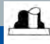
Au moment précis où le goujon et la tôle de base sont mélangés, le goujon est plongé automatiquement dans la matière en fusion.
