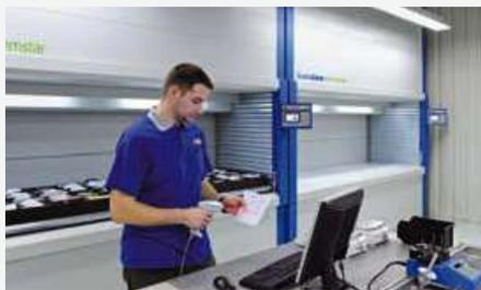
Intégration simple et rapide de lecteurs de code-barres pour l'identification des commandes, des prélèvements et de leur validation.
