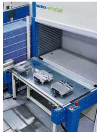
Le dispositif d'extraction automatique a été conçu pour améliorer la maintenance d'articles lourds et volumineux impliquant un équipement de levage ou offrir des possibilités d'interface avec des bras robotisés. Les plateaux sont sortis du sas et présentés devant l'ouverture de prélèvement. Possibilité d'extraction ( chariot, convoyeur ).
