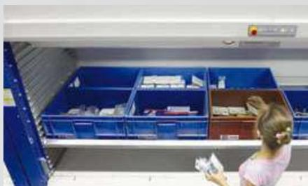
Les parois latérales de l'ouverture de prélèvement sont équipées de profils en L, permettant le positionnement de plusieurs plateaux (double présentation) ainsi que le réglage individuel et personnalisé des hauteurs de travail pour chaque opérateur.
