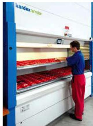
La fonction « Double présentation de plateaux », permet de réduire les temps d'attente et d'augmenter la productivité. Pendant que l'opérateur effectue le prélèvement sur un premier plateau, l'extracteur se déplace en toute sécurité derrière les portes de sécurité, pour préparer le prochain plateau à prélever. Les plateaux sont ensuite rapidement échangés.
