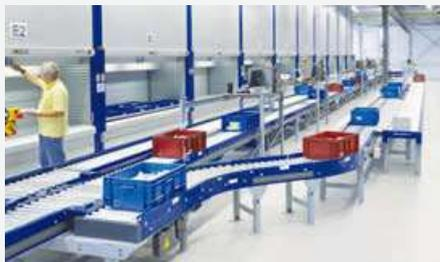
Une solution de transitique peut être idéale pour permettre le regroupement de commandes sur plusieurs zones de picking. L'opérateur assure le prélèvement des articles mis à disposition par le(s) Shuttle XP. Les colis sont ensuite convoyés à la prochaine zone pour être complétés ou expédiés.
