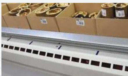
Pour améliorer la productivité de l'opérateur et la fiabilité du picking, Kardex Remstar propose différentes solutions de Pick & Put to light. Le Shuttle XP peut être équipé de solutions Pick to light embarquées (leds de position, afficheurs vario ou matrix, pointeurs lumineux...).
