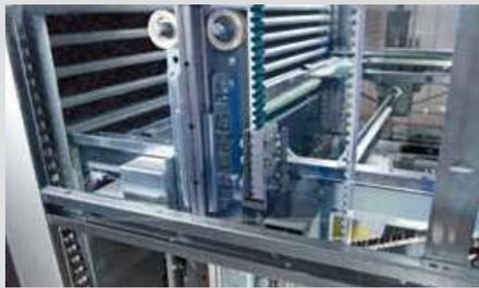
L'extracteur délivre le plateau demandé dans le sas de prélèvement ou le récupère pour le stocker à un emplacement optimal. Il fonctionne en toute sécurité à grande vitesse dans l'enceinte protégée. L'appel d'un plateau se fait manuellement ou par pilotage informatique.
