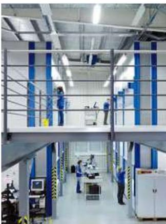
Le Shuttle XP peut être installé et desservir plusieurs étages avec plusieurs ouvertures de prélèvement placées à l'avant ou à l'arrière de la machine. Une implantation à travers une trémie ou une mezzanine peut être réalisée afin de permettre l'utilisation simultanée du stockeur sur plusieurs niveaux.
