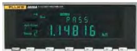
Utilisez les touches de configuration (S1 à S6) pour un accès rapide aux mesures à répétition. Les configurations peuvent inclure un mode de comparaison des limites avec voyants « bons/mauvais ».
