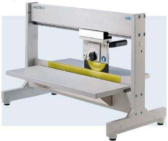
Le séparateur MAESTRO 3E permet la séparation aussi bien des petits que des grands circuits imprimés. La table de dépose peut être continuellement ajustée à la position de travail la plus appropriée. La distance entre la lame linéaire et la table de dépose peut être ajustée pour assurer que les bandes tombent et soient triées.
